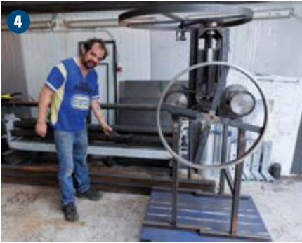
4 ... eine Vorrichtung, mit der die halbierten Rundprofile der anderen Halbschale in Form gebracht wurden.
